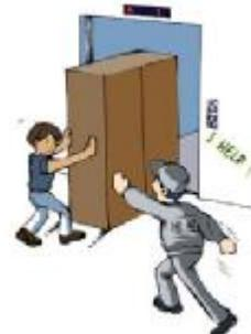
搬运大件物品时，若需保持层、轿门的开启应按住开门按钮“<|>”，禁止用纸板、木条等物品插入层、轿门之间，或用箱子等物件拦阻层、轿门的关闭，以免损坏层、轿门部件，造成危险。
